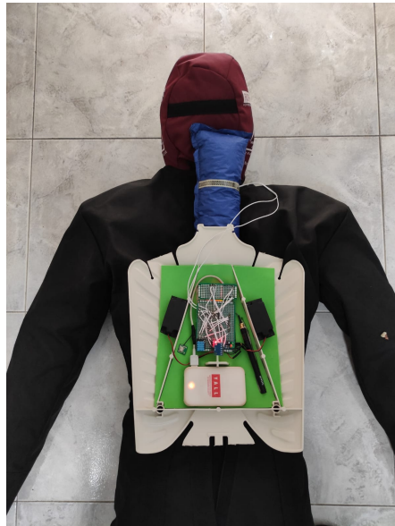
Figura 5.7: Representación de la colocación del sensor de fuerza en el cuello.
