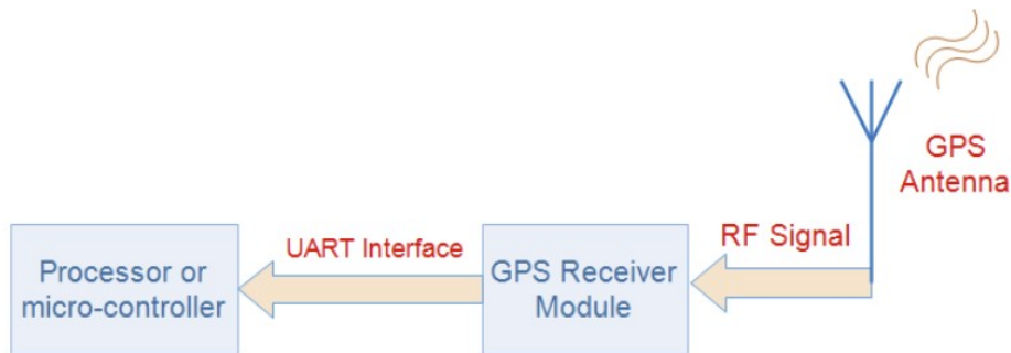
Figura 2.2: Funcionamiento módulo GPS [1].
